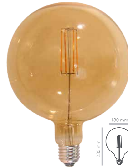
N G180D-LED-4W-FIL/BC Bombilla de LED decorativa tipo esfera 127V~ 4W Base E27 2200 K Terminado Humo Diámetro 180mm Altura 235mm Flujo luminoso 280 lm
